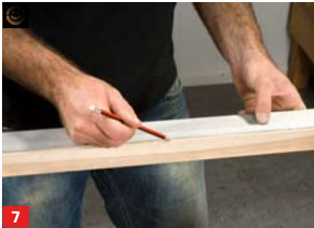
7 Verbinden Sie die Punkte mit Linien entlang einem Lineal. Drehen Sie das Holz um 90° und spannen es fest ein
