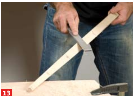
13 Der Rücken bleibt glatt. Wenn die Kontur stimmt, runden Sie die Kanten zum Rücken nur noch leicht ab
