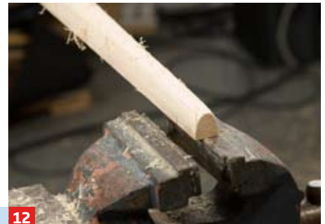
12 ... Bogenenden mit der Raspel gleichmäßig zu. Schön zu sehen ist hier das Bauchprofil des Bogens am Ende
