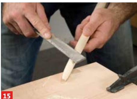
15 Anschließend werden die Nocken ausgearbeitet. Die Kunst besteht darin, so wenig Material wie nötig stehen zu lassen, ...
