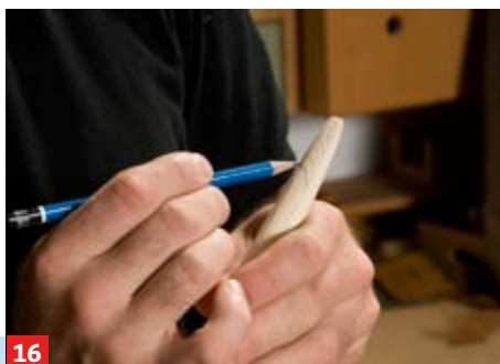
16 ... ohne den Bogen zu sehr zu schwächen. Zeichnen Sie seitlich auf das angespitzte Ende die Sehnenkerben von den Seiten ...
