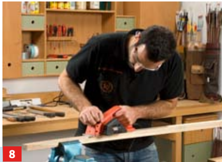
8 Geeignet sind zwei fluchtend montierte Schraubstöcke. Mit dem Elektroholbel arbeiten Sie das Holz bis zum Bleistiftstrich weg
