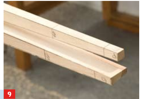
9 Die Arbeitsschritte ab Schritt 6 wiederholen Sie nun auf der Bogenseite. Der Rohling sieht nun aus wie oben im Bild
