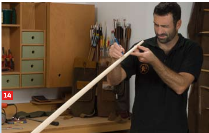
11 ... großen Zügen vom Griff zu den Enden. Prüfen Sie stets den gleichmäßigen Verlauf. Arbeiten Sie dann die ...
