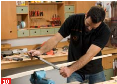
10 Mit der Raspel wird nun der Bogenbauch (zeigt zum Schützen) im „D“-Profil halbrund ausgeformt. Arbeiten Sie in ...
