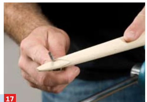
17 ... zum Bauch. Die Sehne benötigt Platz, um sich beim Spannen bewegen zu können. Mit feiner Rundraspel ausarbeiten
